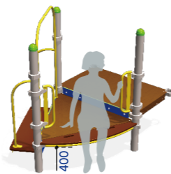
アクセスデッキは車いすから移動しやすい高さで幅、手摺を備えています。
