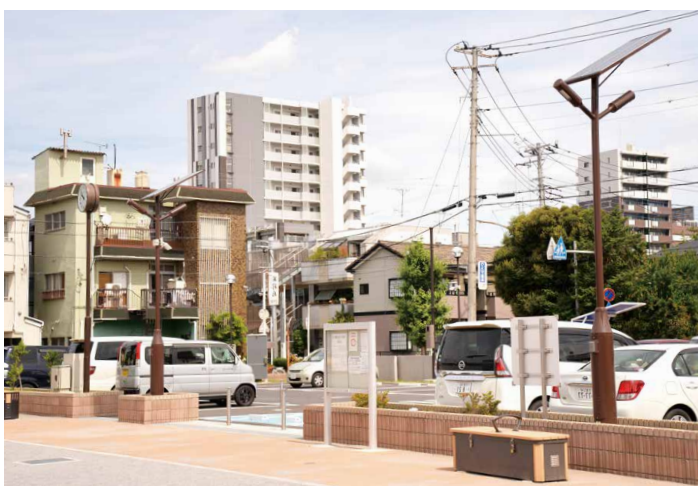
灯具位置を高くする(特注品)ことでLED照明特有の眩しさを軽減します。
