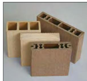
NAウッドは、天然木とプラスチックの廃材を混合して成形し作られた素材です。最大の特徴は、木質感を持ちながらも、木材のような腐朽がみられない点です。屋外においても劣化が少ないため、遊具のデッキなどの材料として利用しています。
