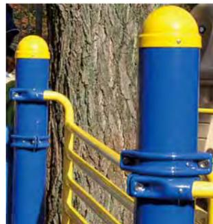
軽くて錆びにくい金属の代名詞のような存在で、飲料缶から窓サッシ、航空宇宙部品まで活躍しています。ナカムラでは、アルミの特性を活かして、鋳物成型、押出し成型などによって形作られたパーツを複合遊具のポストやクランプなどに使用しています。粉体塗装を施すことで、耐久性を更に高めます。
