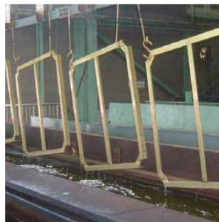
鋼材の表面に亜鉛を電気化学的に結合させた被膜により、防食性を付加する表面処理です。ナカムラでは自社工場内に大型メッキラインを整備し、溶接加工後にメッキ処理を行うことで表面には見えない品質の向上を図っています。
