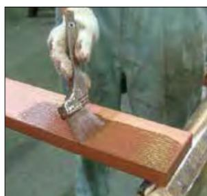
木材は生き物で、設置後も環境の変化に応じて水分の吸収、発散を繰り返します。この作用を妨げないため、ナカムラは基本的に全ての木製品に表面に塗膜を作らずに木材を保護する塗料を使用しています。
