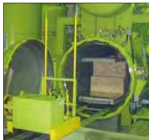
貴重な森林資源を少しでも長く有効に利用するため、ひのきには低毒性木材防腐剤加圧注入処理を施しています。ナカムラでは人体に無害で焼却時にも有毒なガスの発生や有害物質を灰に残すことのないAZN(アゾール・ニコチン系)を主として使用しています。
