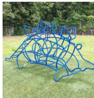
強靱性があり安価で入手しやすく構造用鋼材の中でも最も需要の多い鋼材です。ナカムラが使用しているSS400材は、使用量が圧倒的に多く、鋼管、鋼板、経鋼など多彩な素材形状が流通しており、曲げやプレス、溶接など様々な加工を施して製品化。主に単体遊具やアクセサリに使用しています。
